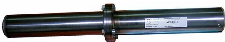
Рис. 1. Автономный регистратор волнения серии АРВ-К14: общий вид
