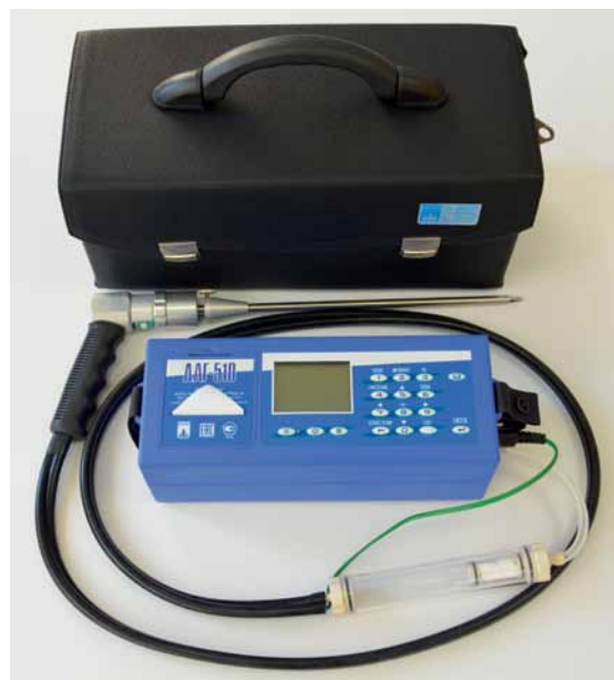
Рис. 2. Переносной газоанализатор ДАГ-510
