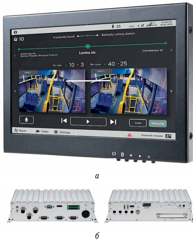
Рис. 1. Центральный бортовой компьютер «ЕвроМобайл»: а – передняя панель с ЖК-дисплеем, б – боковые панели с набором интерфейсов
