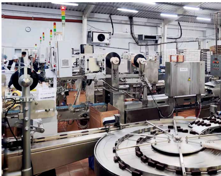
Рис. 1. Светосигнальные колонны MEYERTEC на технологической линии
