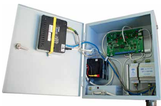
Рис. 2. Каналообразующие устройства в комплексе ТМ88-1
