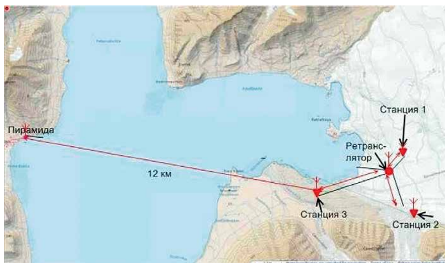
Рис. 2. Общая схема радиосети для инструментального мониторинга состояния ледника Норденшельда (арх. Шпицберген)
