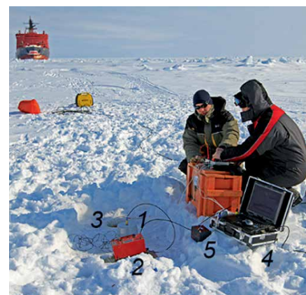
Рис. 1. Схема размещения приборов на ровном льду при экспериментах с движением ледокола «Ямал»: 1 – сейсмометр; 2 – наклономер; 3 – деформометр; 4 – регистратор, 5 – набор аккумуляторов; радиомодем с антенной – за кадром
