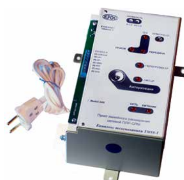
Рис. 2. Каналообразующие устройства в комплексе ТМ88-1
