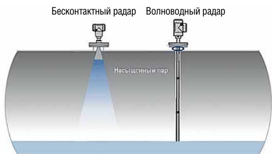
Насыщенный пар и (или) конденсация на антенне вызывают дополнительную погрешность
