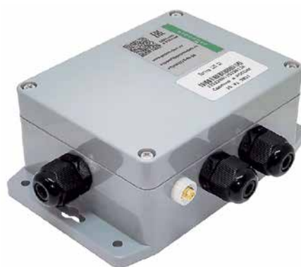
Рис. 5. Автономный промышленный модем PROMODEM GSM-125.09M с двумя портами RS-485 + RS-232 для подключения любых приборов учета, степенью защиты IP65 и батареей на несколько лет автономной работы; температура эксплуатации от -40 до +70 °C
