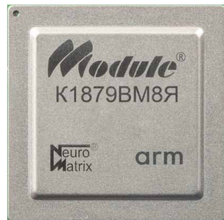
Рис. 3. Микросхема K1879BM8Я производства НТЦ «Модуль»
