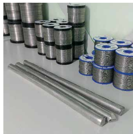
Рис. 10. Припой производства АО «НИТИ «Авангард»: а – катушки с припоем разного диаметра; б – экструдированный припой (пруток) и катушки с припоем
