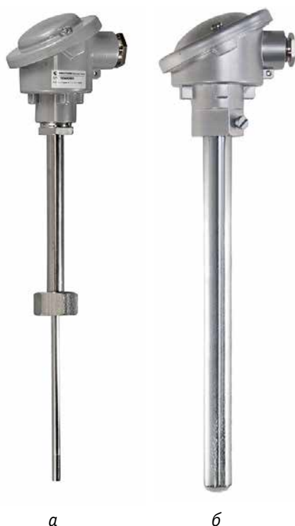
Рис. 2. Два исполнения из линейки термопар: а – для установки в защитную гильзу; б – модель, рассчитанная на высокие температуры
