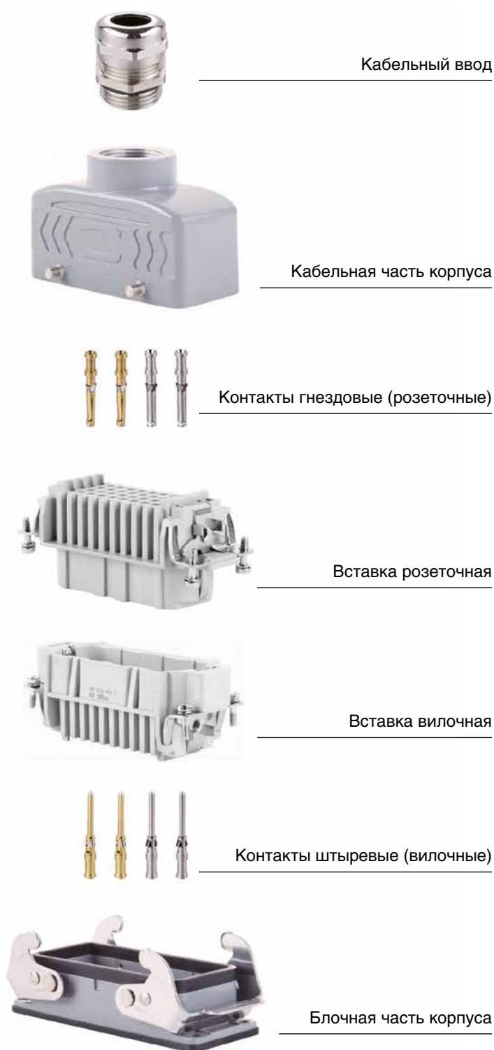
Рис. 2. Компоненты промышленного разъема ЭЛМИ
