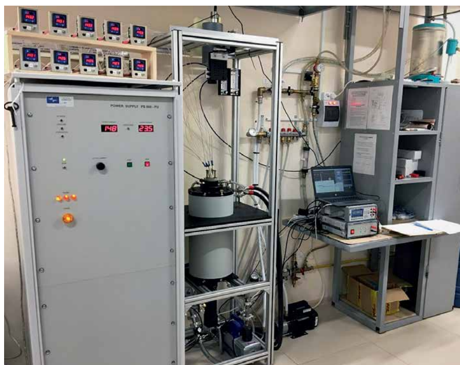
Рис. 2. Установка для калибровки высокотемпературных термопреобразователей
