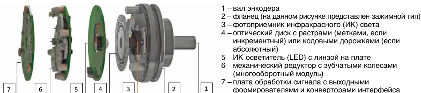
Рис. 2. Оптоэлектронный энкодер, работающий на просвет
