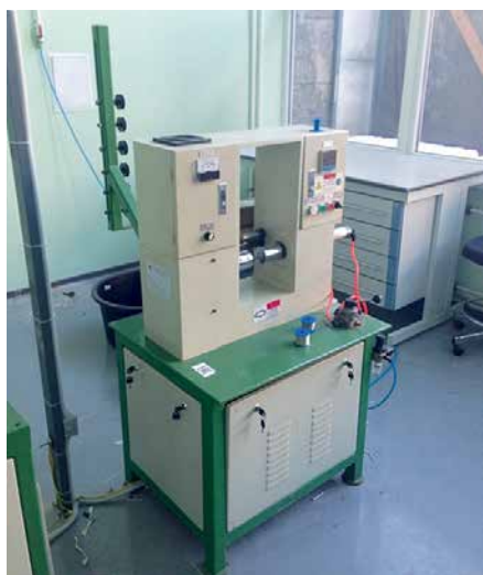
Рис. 9. Намоточный станок VT-06A
