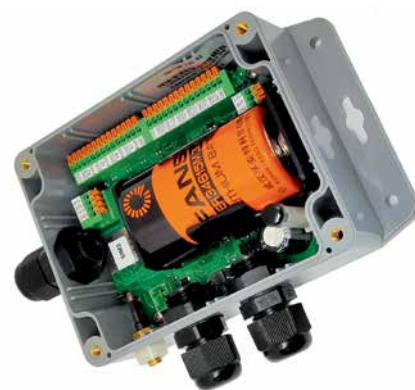
Рис. 5. Автономный промышленный модем PROMODEM GSM-125.09M с двумя портами RS-485 + RS-232 для подключения любых приборов учета, степенью защиты IP65 и батареей на несколько лет автономной работы; температура эксплуатации от -40 до +70 °C
