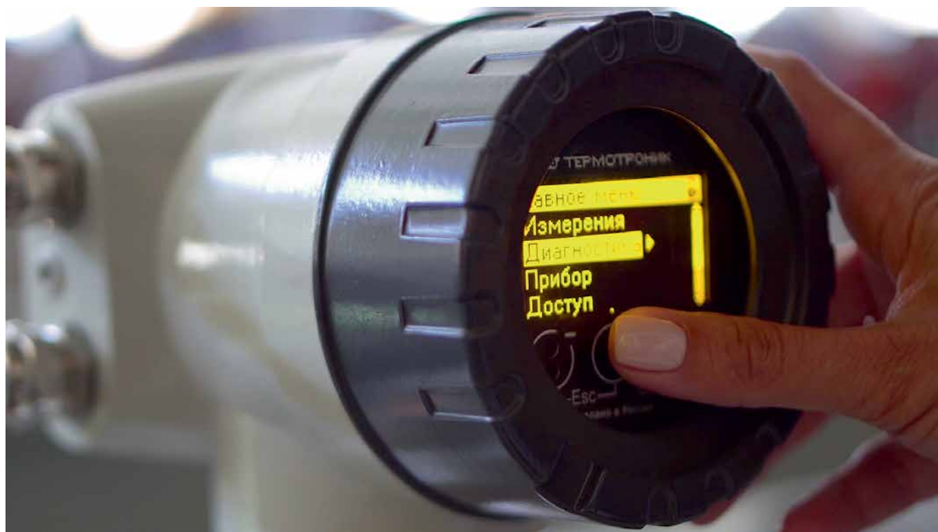
Рис. 3. Настройка промышленного расходомера ПИТЕРФЛОУ Т3
