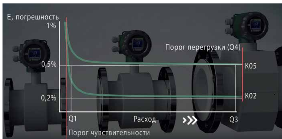
Рис. 4. Относительная погрешность измерений расходомеров Питерфлоу Т
