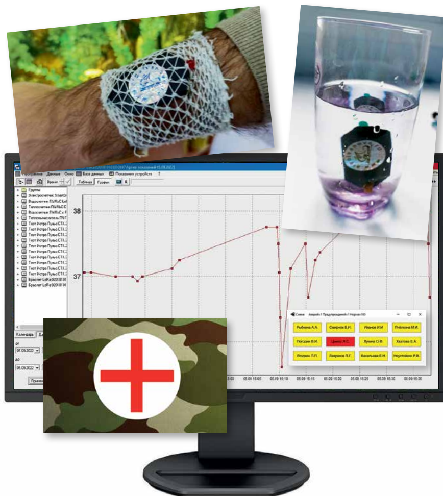
Рис. 1. Датчик на руке пациента передает сигналы о его состоянии в систему по беспроводной LoRaWAN-связи
