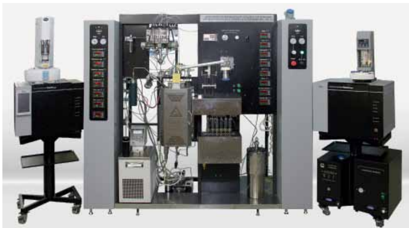
Рис. 3. Автоматическая шестиканальная установка испытаний процесса углубленного крекинга (АСЕ) катализаторов каталитического крекинга в псевдооживленном слое (FCC)
