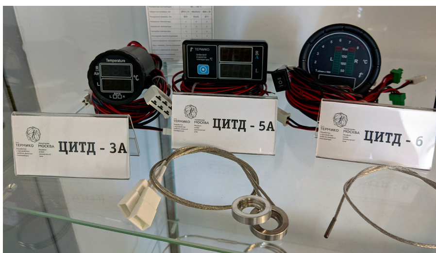
Рис. 3. Индикаторы температуры двигателей ЦИТД
