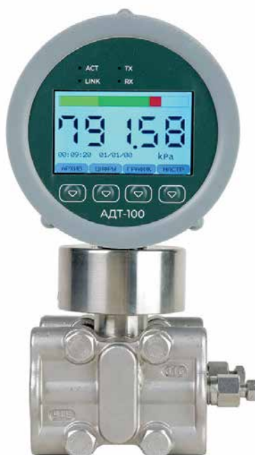
Рис. 1. Измеритель разности давлений АГАВА АДТ-100Д
