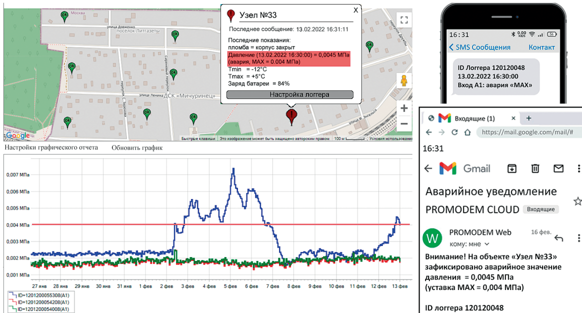
Рис. 2. Извещения об аварийных событиях: слева – индикация на веб-карте системы диспетчеризации PROMODEM CLOUD; справа – примеры аварийных e-mail- и СМС-сообщений на телефоны сотрудников
