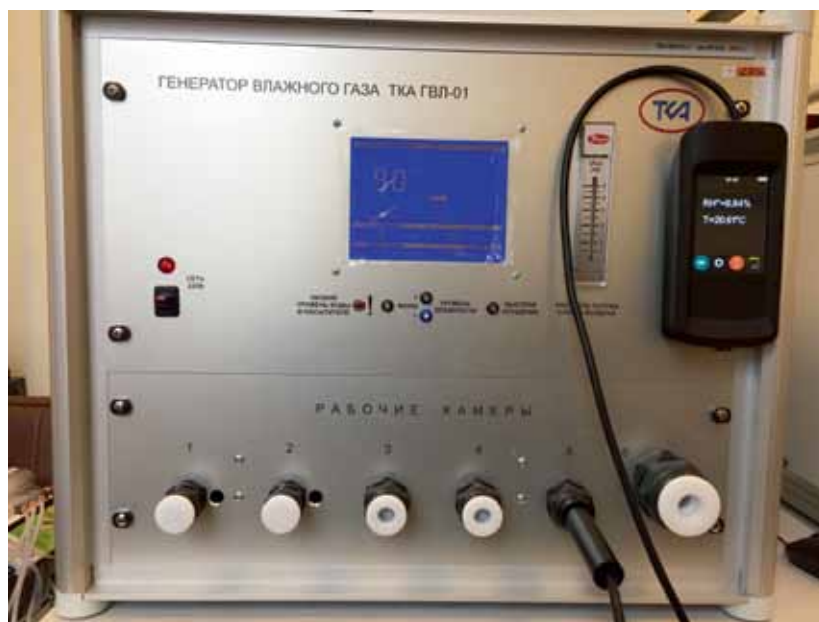
Рис. 4. Термогигрометр эталонный «ТКА-ТВ/Эталон» в составе генератора влажности «ТКА-ГВЛ-01»
