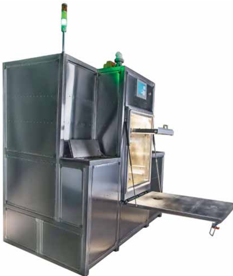
Рис. 1. Установка вакуумной очистки УСОТП
