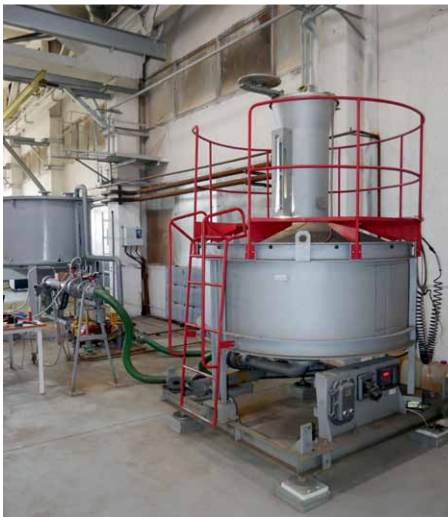
Рис. 3. Установка поверочная УПМ-М 2000 объемно-массовым методом
