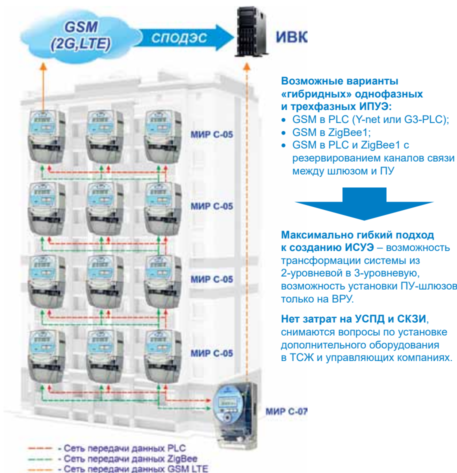
Рис. 2. Архитектура интеллектуальной системы учета НПО «МИР» в 9-этажном доме
