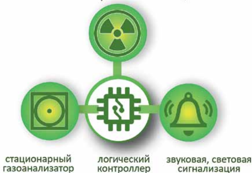
Рис. 1. Структурная схема системы противаварийной защиты «СервисСофт Инжиниринг»
