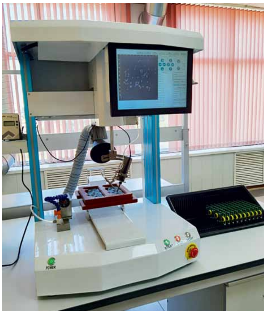
Рис. 2. Роботизированная установка для выводного монтажа (ТНТ)
