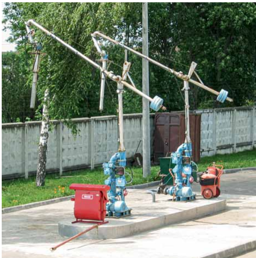
Рис. 1. Автоматизированная система налива АСН-5М «Дельта»
