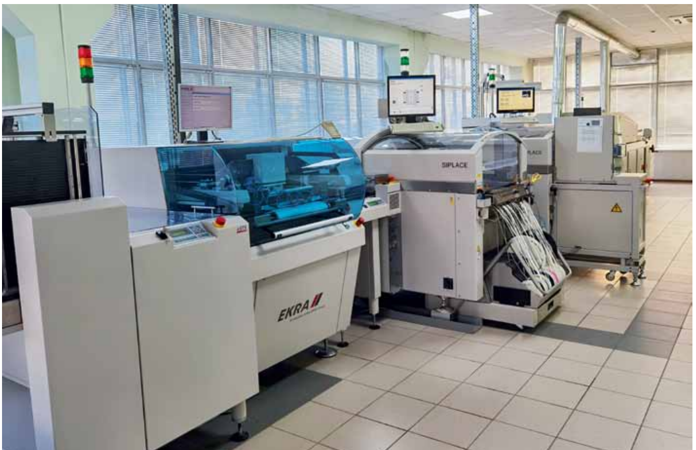
Рис. 1. Цех АО НПЦ «Спектр» для поверхностного монтажа (SMT)
