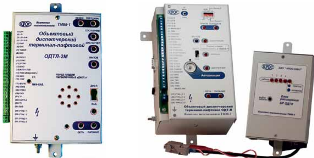
Рис. 2. Лифтовые блоки ОДТЛ-2М на два и ОДТЛ-4.1 на четыре лифта
