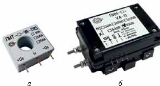
Рис. 1. Преобразователи для измерения токов и напряжения: а – миниатюрный датчик для измерения постоянного и переменного токов до 150 А с отверстием под токовую шину, увеличенным до 15 мм; б – датчик для контроля напряжения до 1000 В
