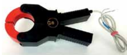
Рис. 6. Токовые клещи без кольцевого магнитопровода для контроля токов до 10000 А
