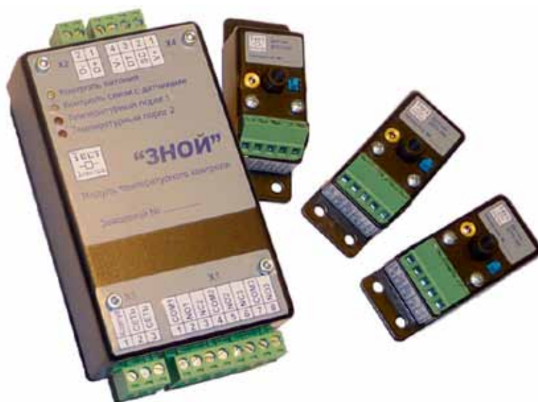
Рис. 1. Элементы системы многоканального бесконтактного температурного контроля «Зной»
