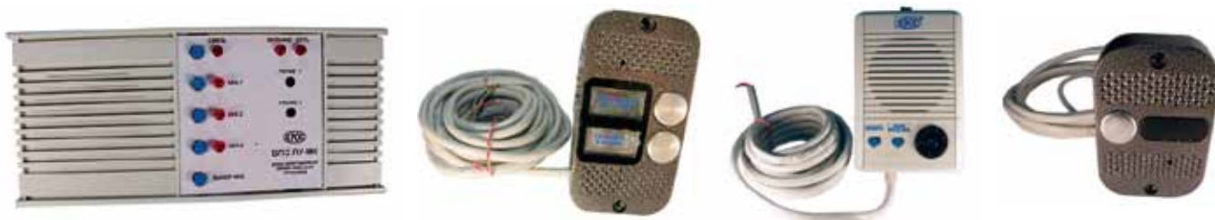
Рис. 3. Оборудование переговорной связи в комплексе ТМ88-1
