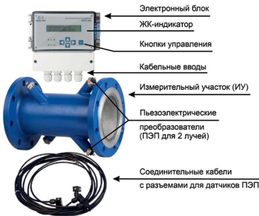
Рис. 2. Состав исполнения ультразвукового расходомера УРС-003 с поставляемым измерительным участком
