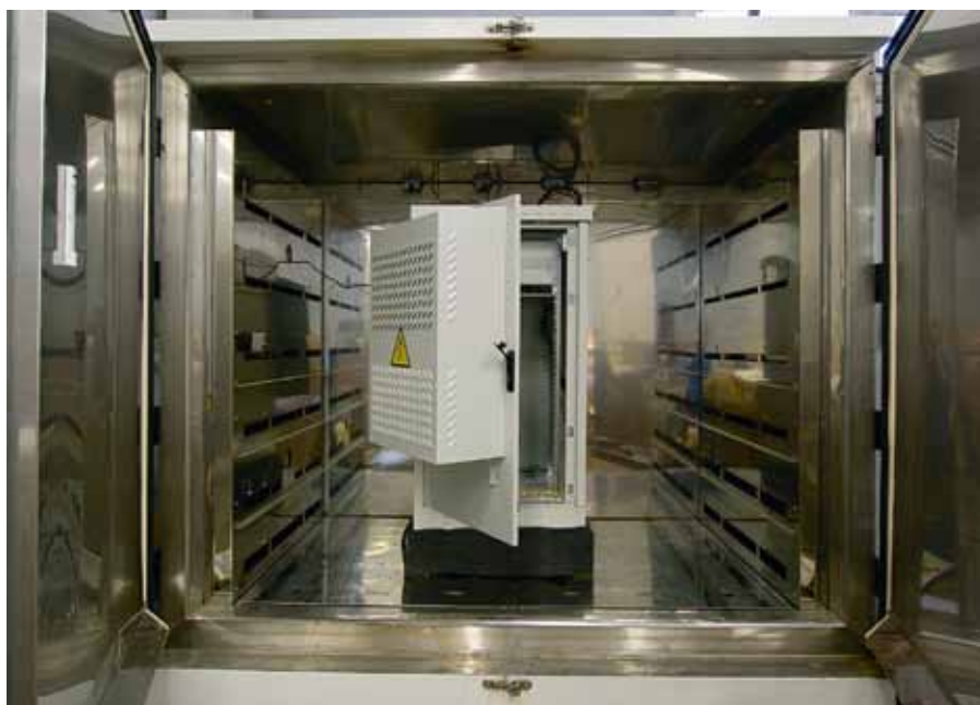
Рис. 1. Всепогодный шкаф ШТВ в термокамере на испытаниях
