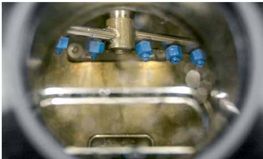
Рис. 1. Установка вакуумной очистки УСОТП: вид внутри
