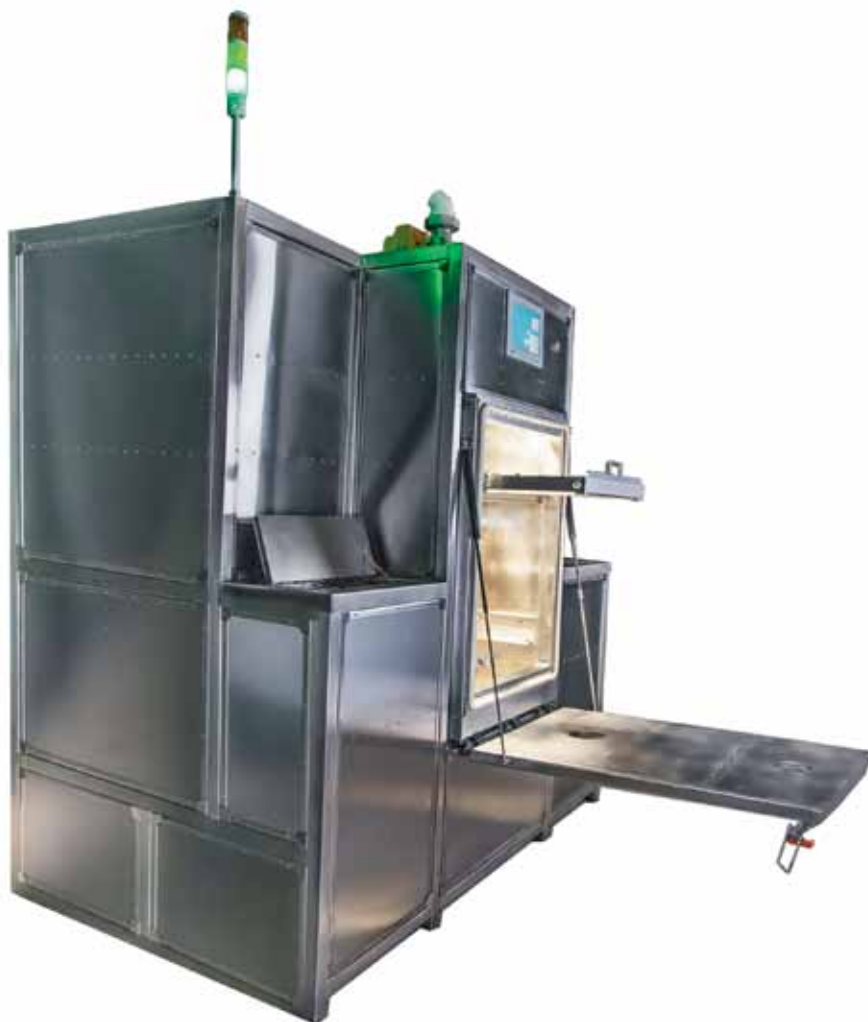
Рис. 2. Установка вакуумной очистки УСОТП: общий вид
