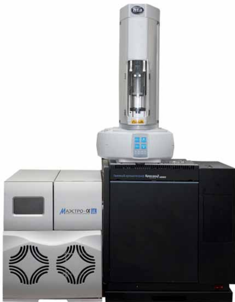
Рис. 2. Система ГХ/МС: газовый хроматограф «Кристаллюкс-4000М» и масс-спектрометр «Маэстро-αМС»
