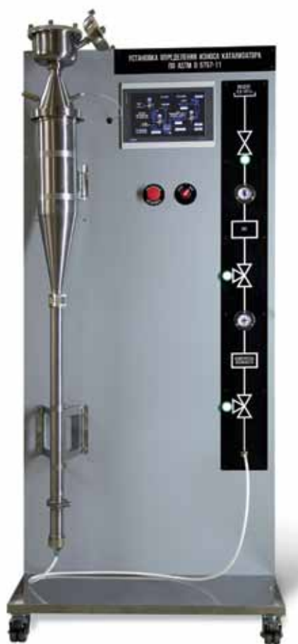
Рис. 3. Установка определения износа катализатора по ASTM D 5757-11
