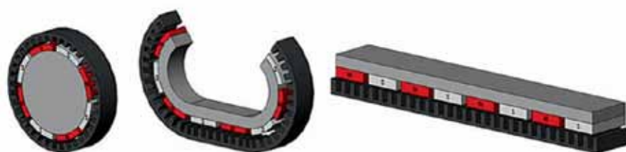
Рис. 2. Схематичное изображение кругового и линейного двигателей
