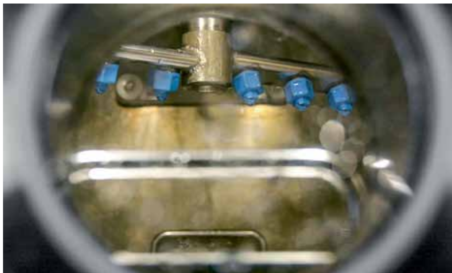
Рис. 1. Установка вакуумной очистки УСОТП: вид внутри
