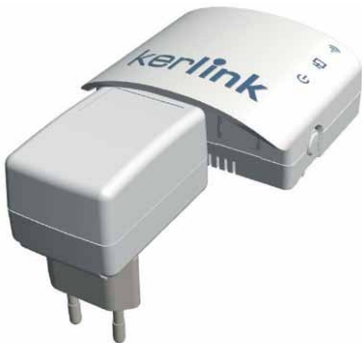
Рис. 2. Модель Wirnet iZeptoCell Cellular с многовилочным блоком питания
