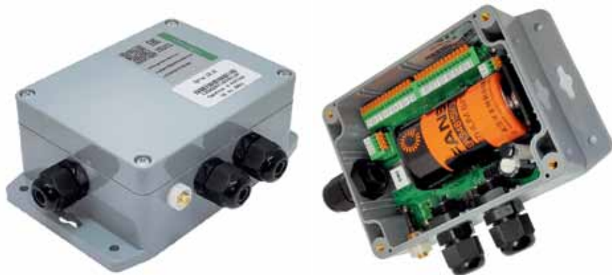
Рис. 6. Автономный промышленный модем PROMODEM GSM-125.00М с двумя портами RS-485 + RS-232 для подключения оборудования разного типа, степень защиты IP65 и батарей на несколько лет автономной работы; температура эксплуатации – от –40 до +70 °С
