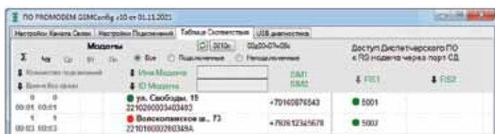
Рис. 9. Диагностика в диспетчерской: индикация и статистика подключений модемов PROMODEM GSM к серверу в программе настройки и мониторинга PROMODEM GSMConfig
