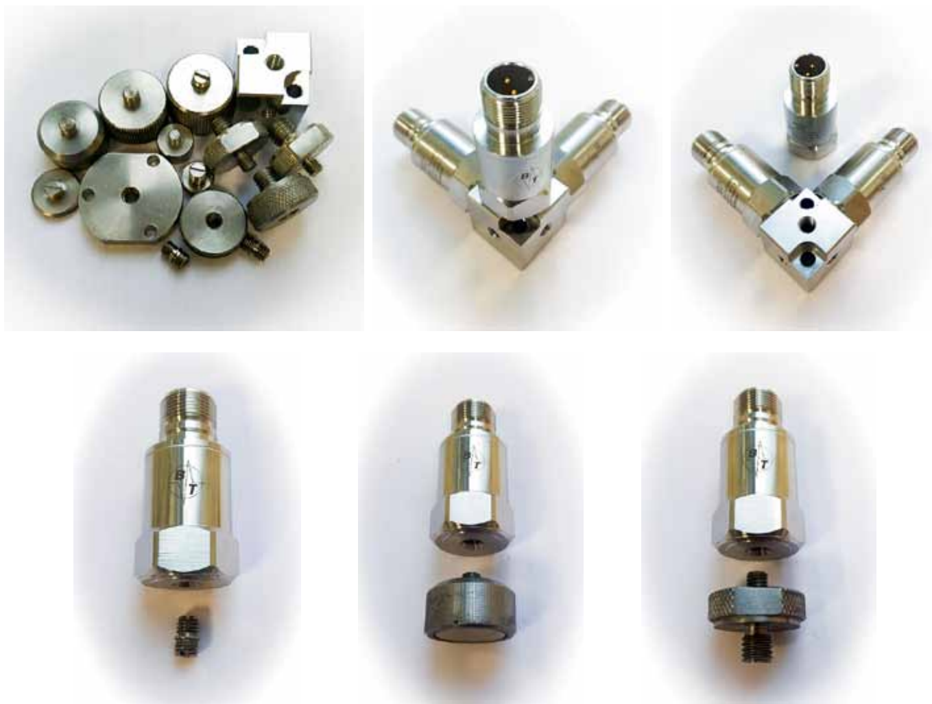
Рис. 6. Акселерометр А603С01 с переходными адаптерами
