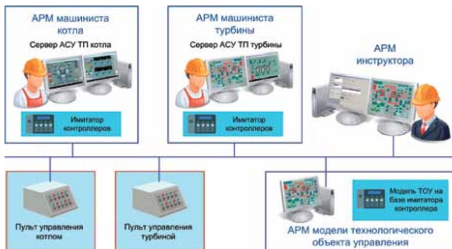
Рис. 4. Структурная схема компьютерного тренажерного комплекса
