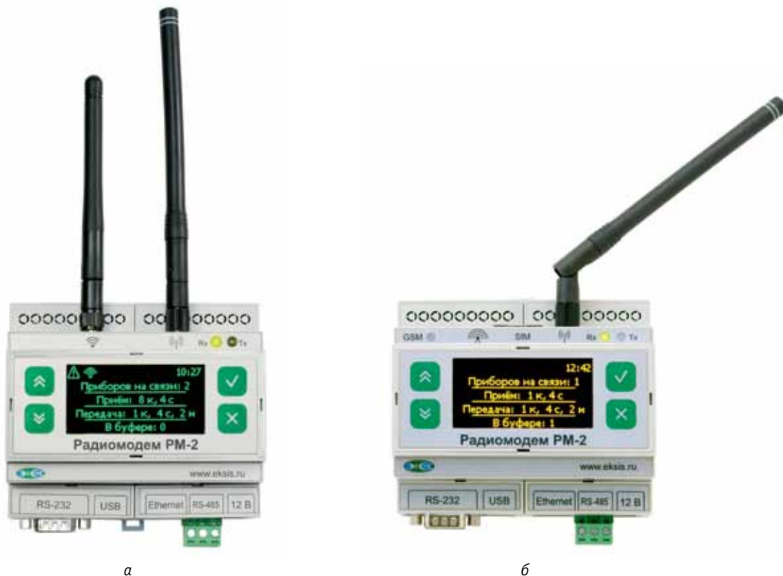
Рис. 3. Радиомодем PM-2-L: а – модификация PM-2-L W; б – модификация PM-2-L G
