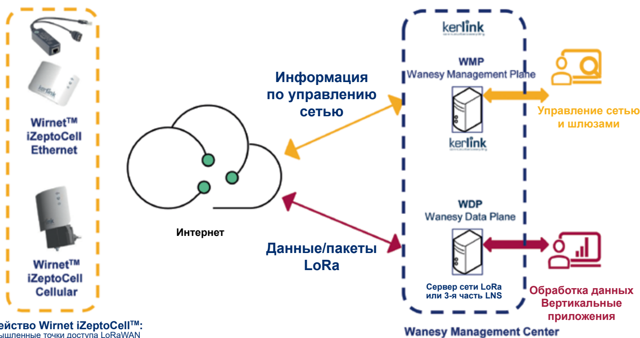
Рис. 3. Сеть интернета вещей, построенная на базе шлюзов Wirnet iZeptoCell и ПО Wanesy Management Center
