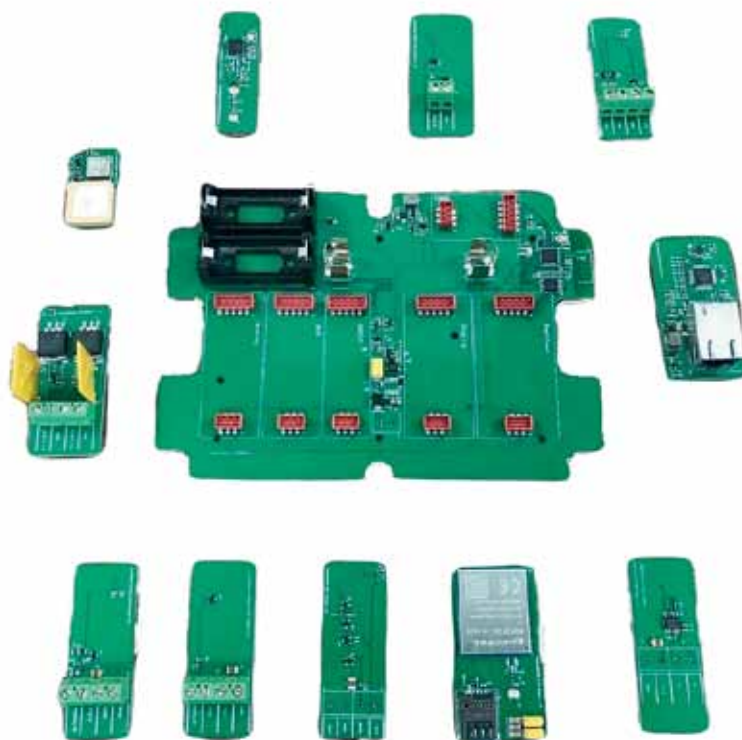
Рис. 1. Контроллер AuroraNode: материнская плата и сменные модули
