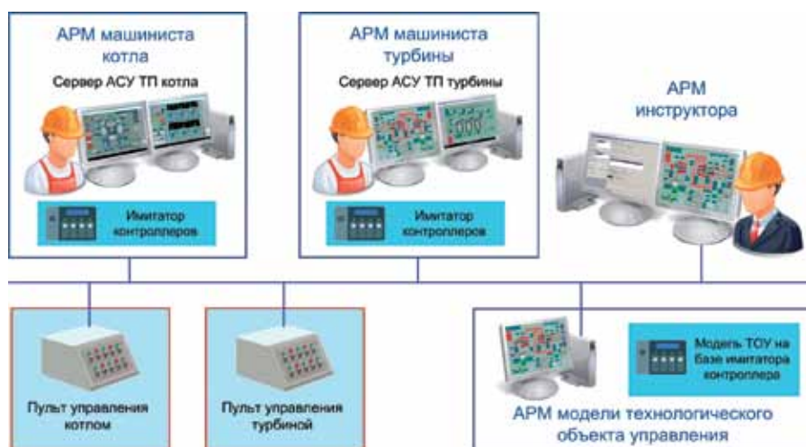
Рис. 4. Структурная схема компьютерного тренажерного комплекса
