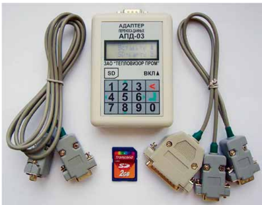
Рис. 1. Адаптер переноса данных АПД-03 с коммутационными кабелями и SD-картой
