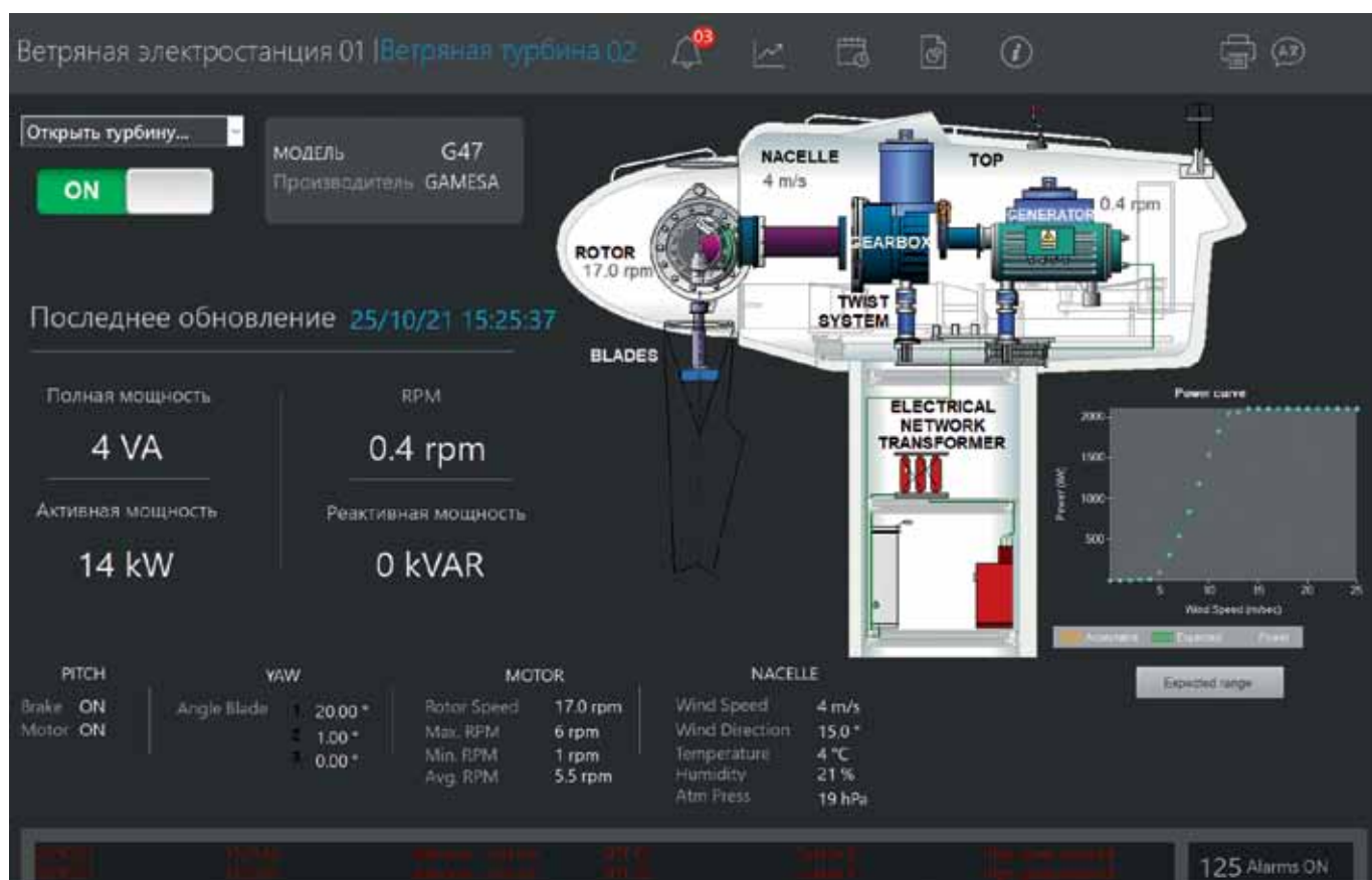
Рис. 1. Пример мнемосхемы SCADA PcVue
