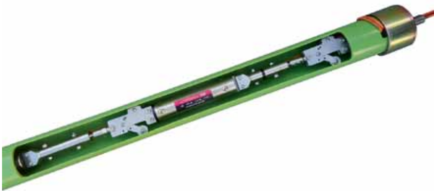
Рис. 4. Многоточечный скважинный инклинометр
