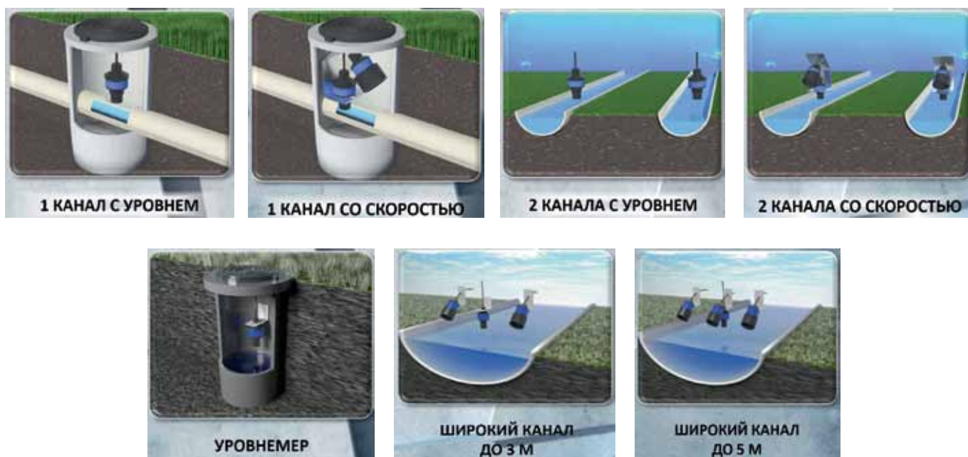
Рис. 4. Схемы измерений модификации расходомера «ВоСток» с ультразвуковым датчиком уровня ДУ-3
