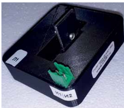
Рис. 6. Малогабаритные трансформаторы тока с выходом 5(1) А
