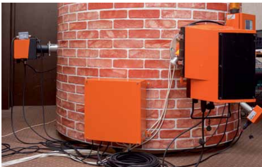
Рис. 4. Оборудование автоматической системы контроля выбросов/сбросов
