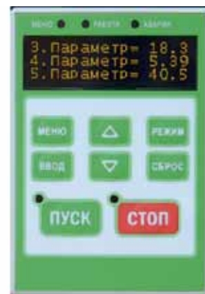
Рис. 3. Модуль индикации АГАВА МИ-60
