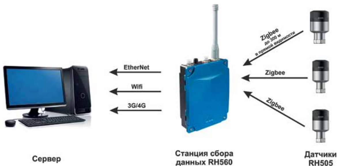
Рис. 3. Архитектура системы CMS
