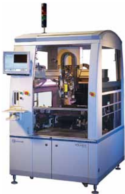
Рис. 2. Универсальная платформа Polaris для OFA-монтажа
