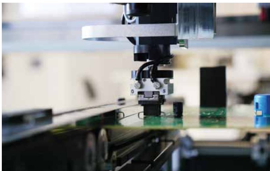
Рис. 4. Различные функциональные головы и оснастка станков для OFA-монтажа
