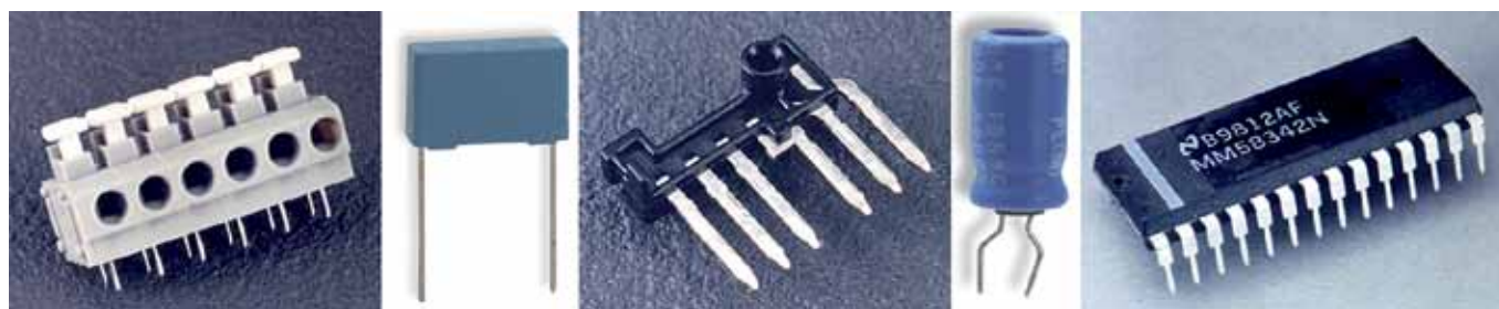
Рис. 1. Компоненты с OFA-монтажом
