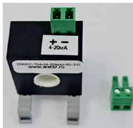
Рис. 2. Электронный трансформатор тока ТП05С с выходом 4–20 мА
