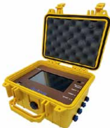
Рис. 1. Электронный вычислительный блок расходомера «ВоСток»: а – стационарный; б – переносной
