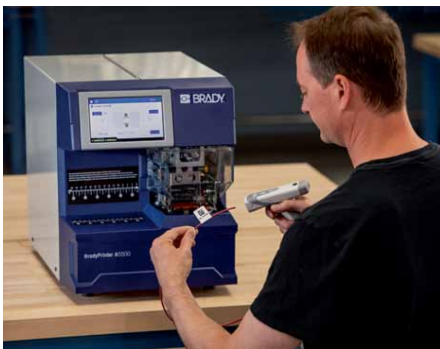
Рис. 5. QR-код на флажковой этикетке
