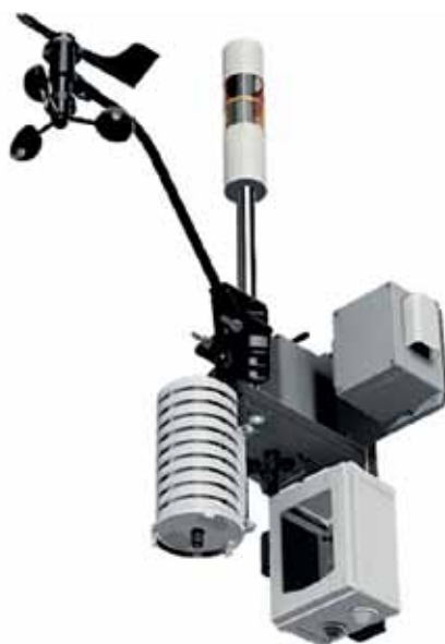
Рис. 6. Пример совмещения поста комплексной системы экологического мониторинга с метеостанцией и сигнальной системой
