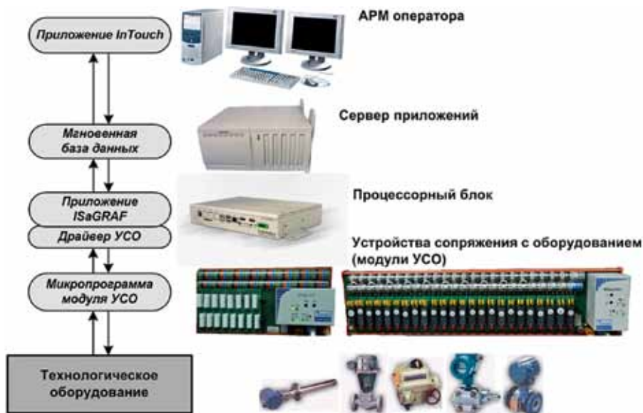
Рис. 3. Обработка сигналов в распределенной системе управления
