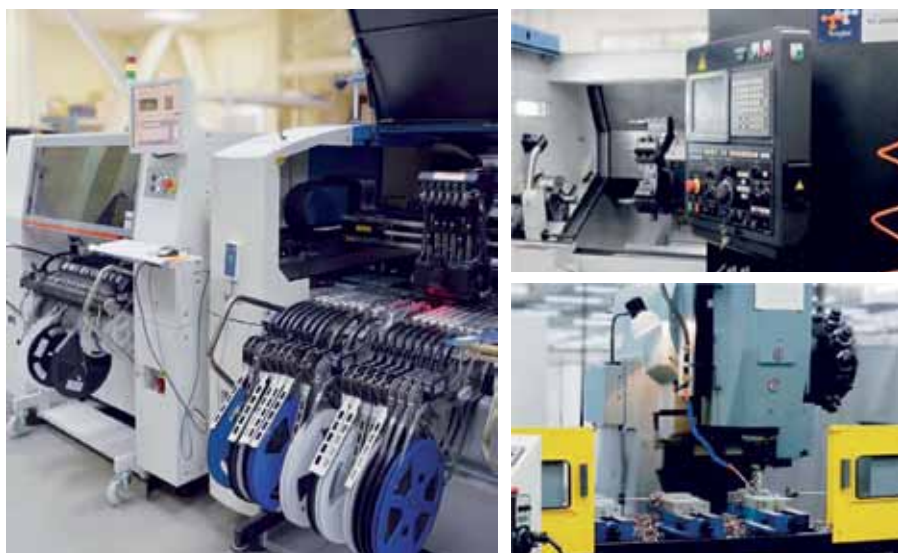
Рис. 2. Автоматизированная линия по установке и пайке компонентов и высокотехнологичные обрабатывающие центры
