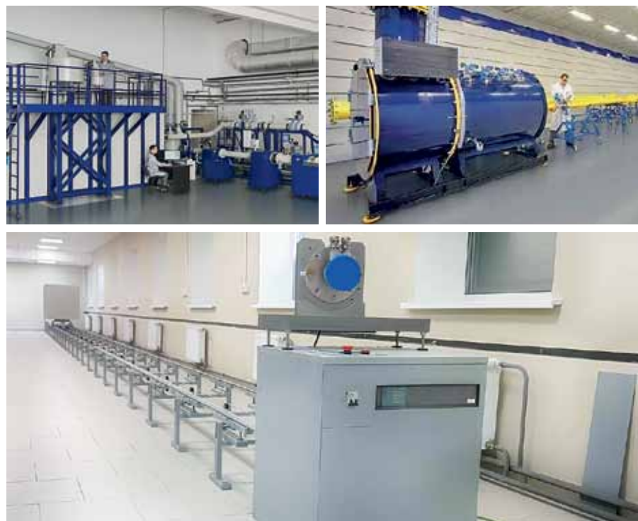
Рис. 3. Поверка расходомеров и уровнемеров
