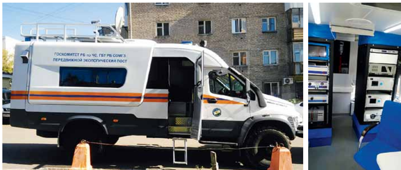
Рис. 2. Передвижная лаборатория экологического контроля и бортовое оборудование
