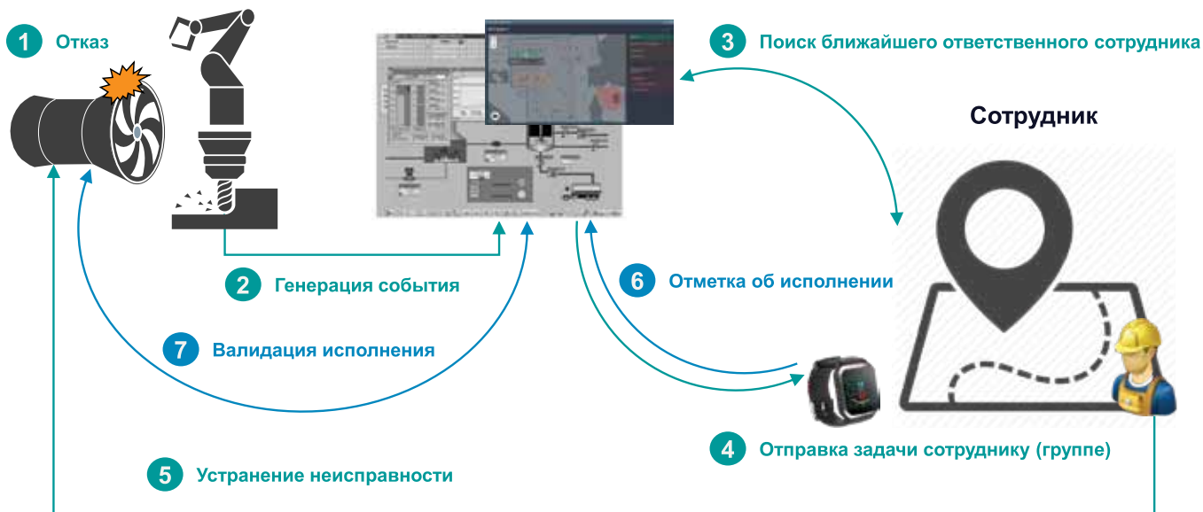
Рис. 3. Сценарий реагирования на отказ производственного оборудования
