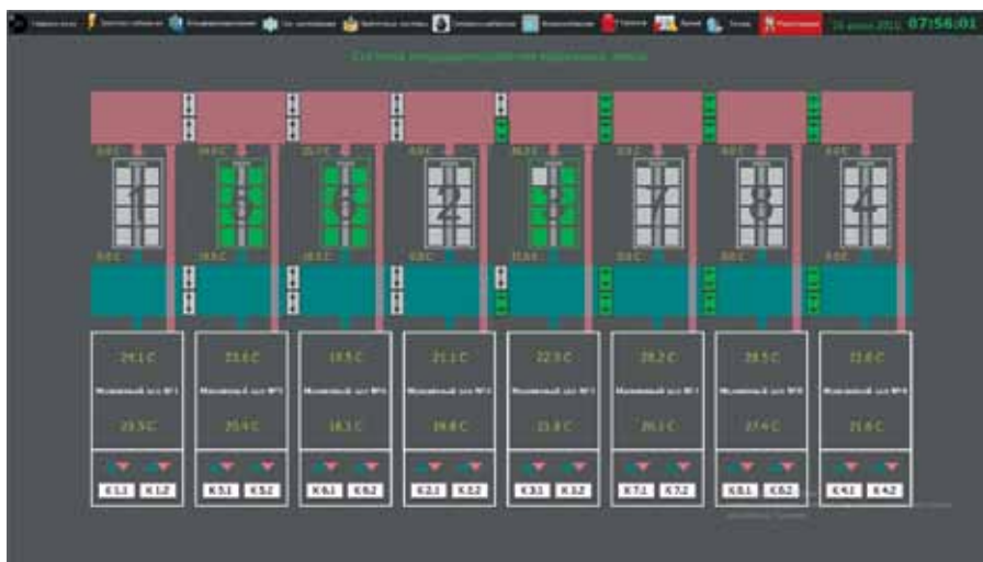
Рис. 2. Мониторинг системы кондиционирования машинных залов
