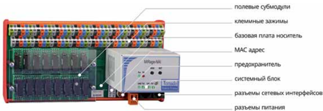
Рис. 2. Устройство ввода/вывода серии MIRage-N
