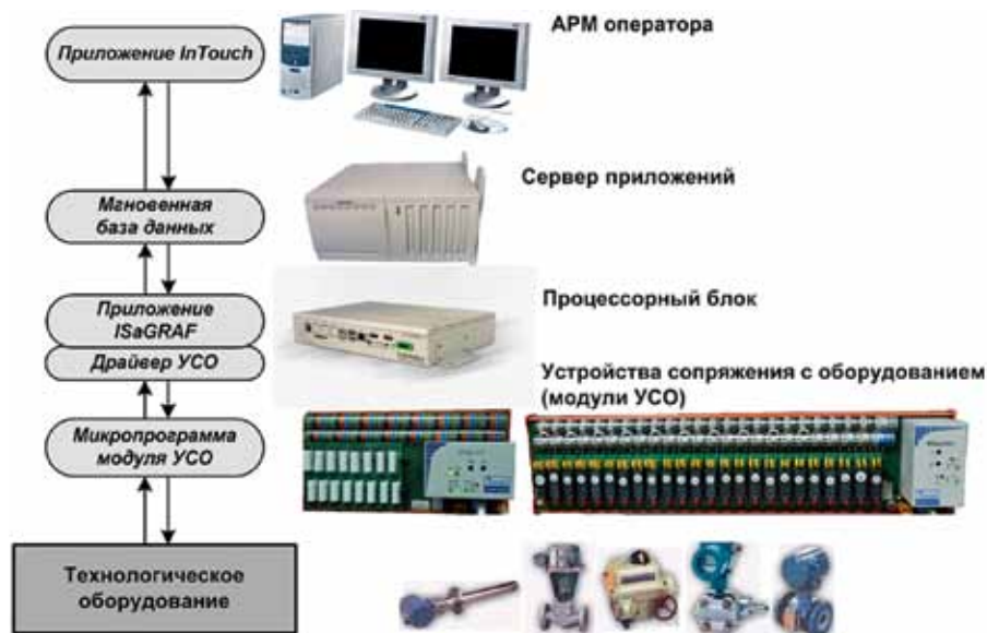
Рис. 3. Обработка сигналов в распределенной системе управления
