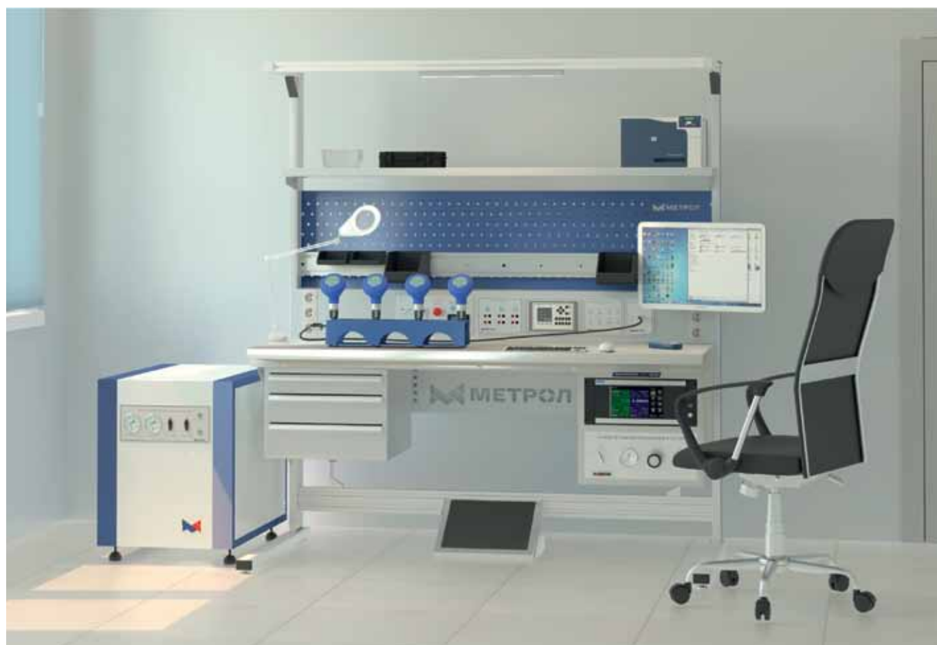
Рис. 2. Метрологический стенд для поверки, калибровки и ремонта средств измерения давления
