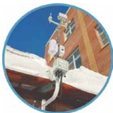
Рис. 3. Пост экологического мониторинга, установленный на объекте
