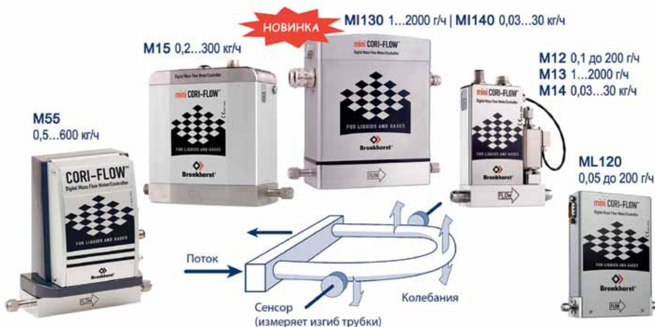
Рис. 1. Кориолисовые расходомеры и их принцип измерения
