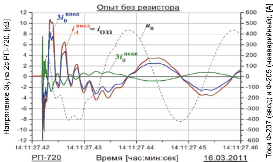
Рис. 1. Опыт металлического однофазного замыкания на землю
