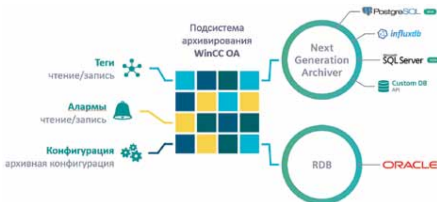
Рис. 7. Архитектура подсистемы NGA в WinCC OA версии 3.18
