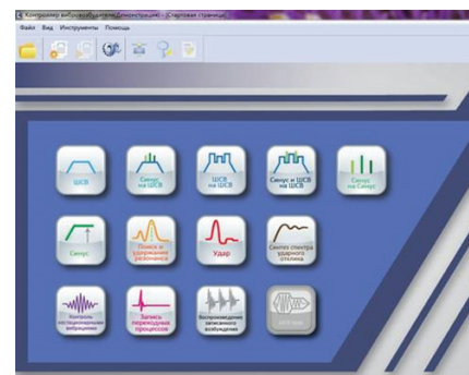
Рис. 3. Интерфейс системы управления виброустановкой
