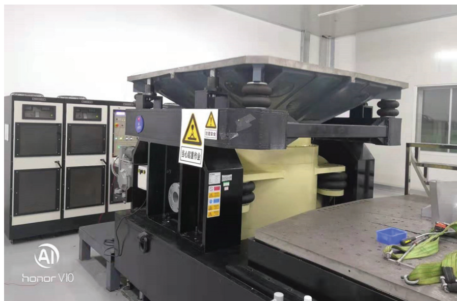
Рис. 1. Трехосевая виброиспытательная система для оборудования до 1200 кг. Номинальная вынуждающая сила – 311 кН; удар – 620 кН
