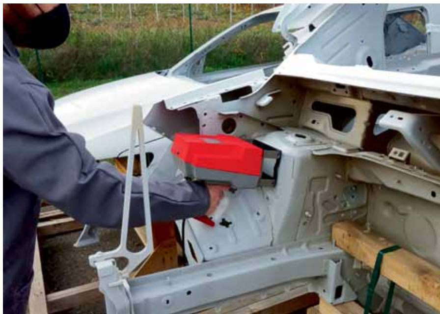
Рис. 3. Маркировочное окно E-Touch XL в четыре раза больше по площади, чем у E-Touch
