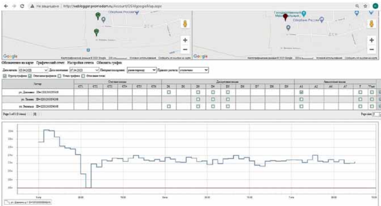
Рис. 2. Пример графического отчета по уровню воды в скважине, сформированного в информационной системе PROMODEM LOGGER
