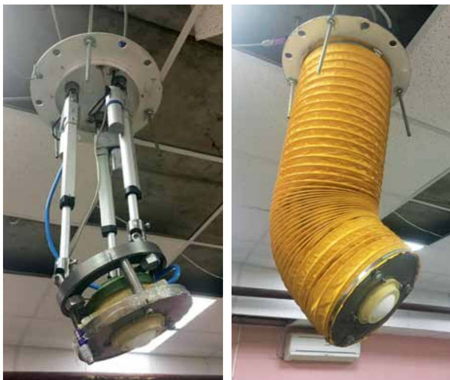
Рис. 1. Система измерения объемов «Скан-200» с тремя линейными двигателями, позволяющими поворачивать радар: в открытом виде и в защитном кожухе
