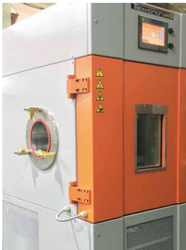
Рис. 3. Камера КТХВ-150 с нестандартным технологическим отверстием
