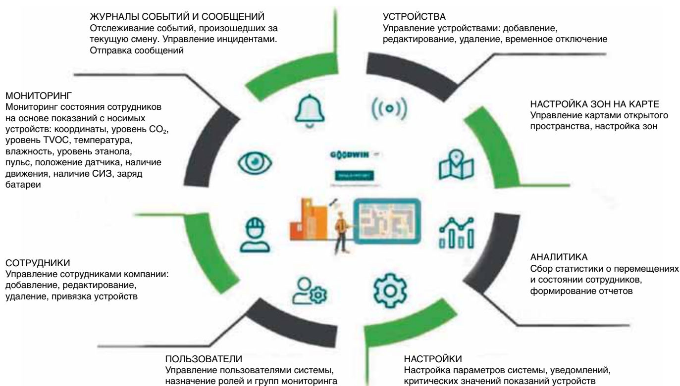
Рис. 3. Функции и настраиваемые параметры платформы Goodwin-IoT
