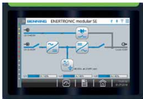
Рис. 7. Графическое отображение режимов работы ИБП: слева – мнемосхема, справа – сенсорный экран 10,4 дюйма
