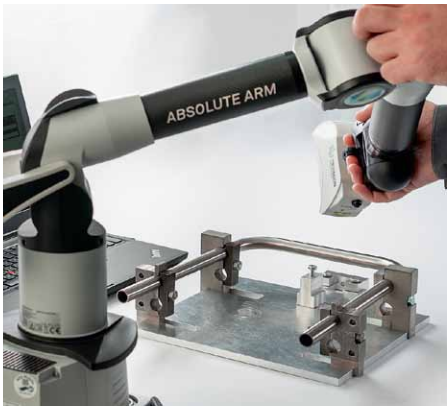
Рис. 3. Контроль геометрии измерительных трубок с помощью координатно-измерительной 3D-установки на заводе «ЭлМетро»
