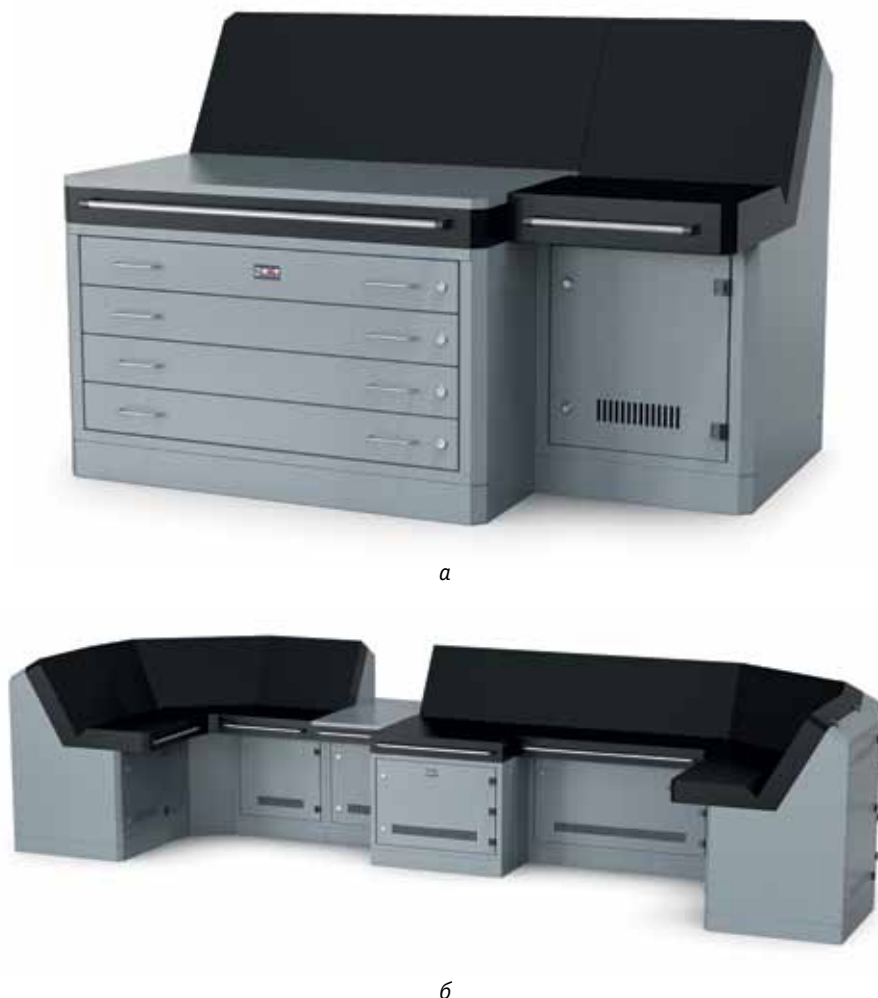
Рис. 3. Пулты управления для катера-торпедолова: а – штурманский стол; б – центральный пулт управления
