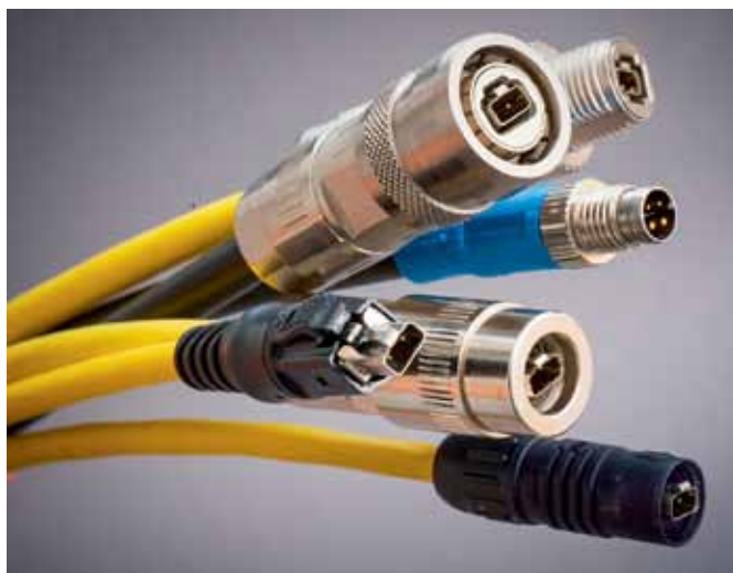
Рис. 1. Новые IoT-компоненты HARTING: соединители T1 (слева) и RJ45 Multifeature (справа) для передачи данных по SPE
