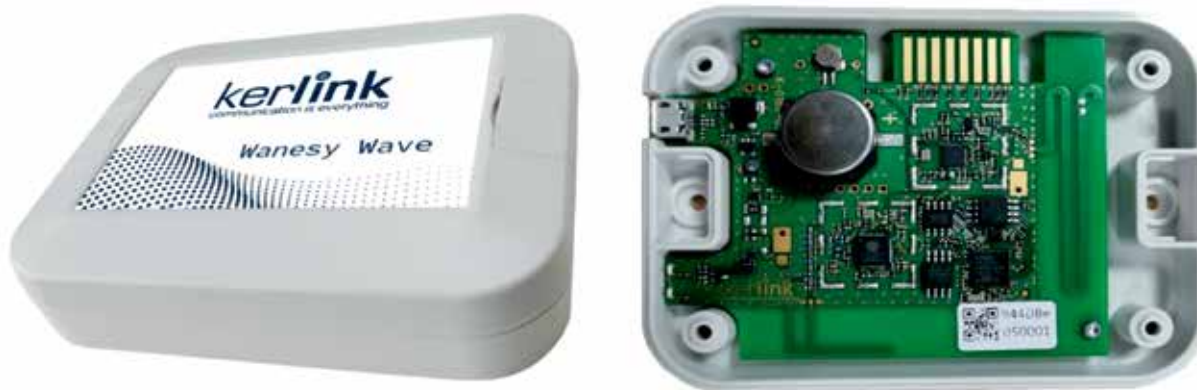
Рис. 3. Внешний вид трекера Wanesy Wave
