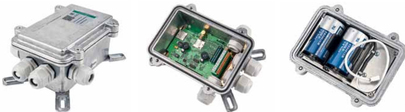
Рис. 1. Логгер PROMODEM: вариант исполнения IP68, до 10 лет работы от батареи
