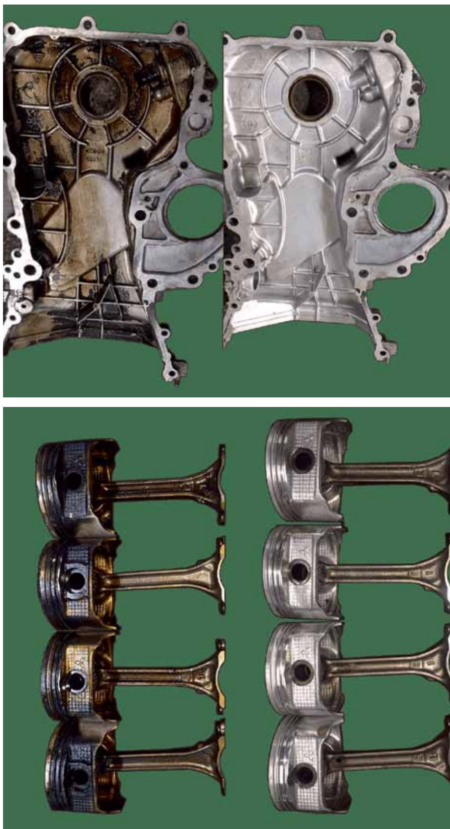
Рис. 3. Детали до и после отмывки в ультразвуковой ванне с применением технического моющего средства «ХимТехПРОМ»
