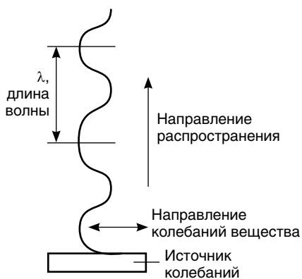
Рис. 1. Смещение среды вследствие колебаний, вызываемых источником ультразвука
