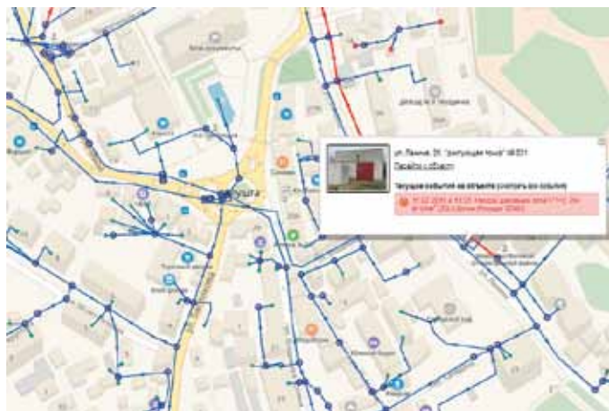
Рис. 12. Интерактивный анимированный веб-интерфейс облачной системы диспетчерского контроля ZuluGIS
