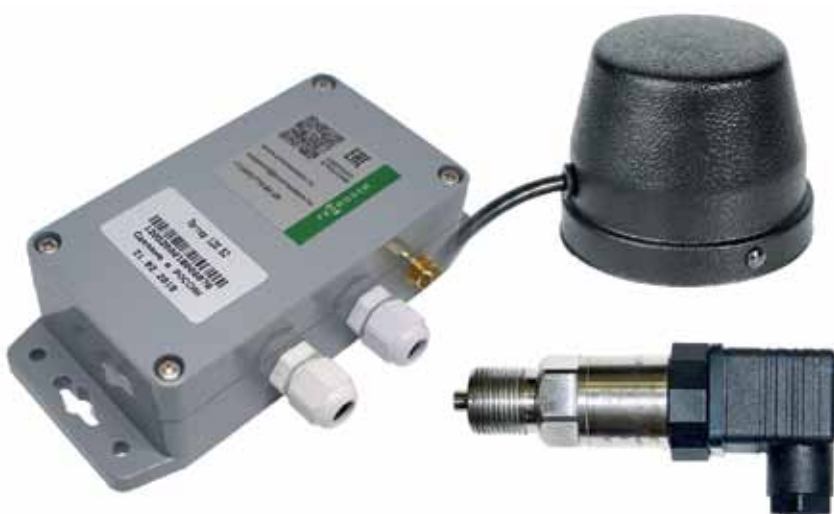
Рис. 6. IP65-комплект «Датчик давления PROMODEM GSM 830.07»
