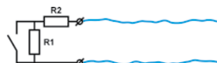
Рис. 2. Контакт с контролем целостности цепи
