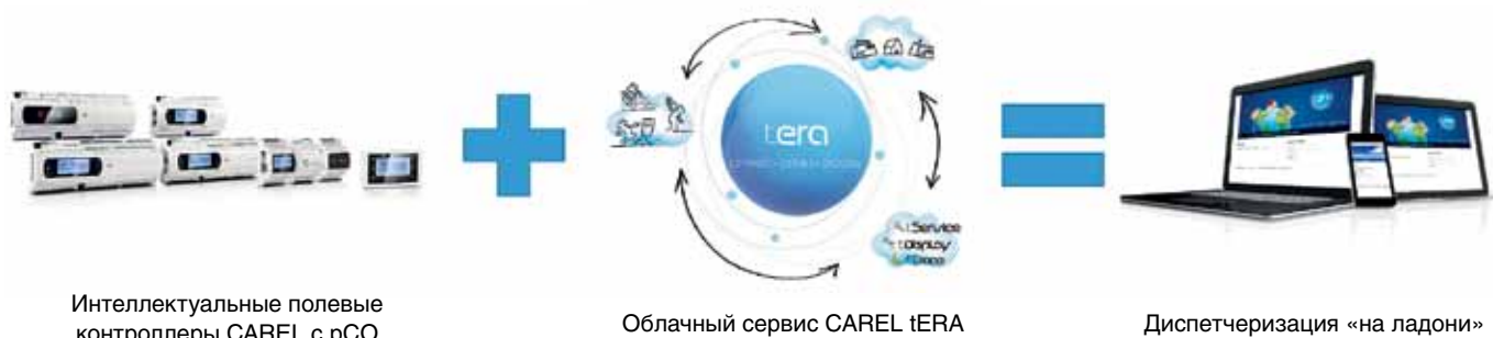
Рис. 1. Сервис диспетчеризации CAREL tERA интегрирует в единую систему диспетчеризации даже локальные удаленные системы
