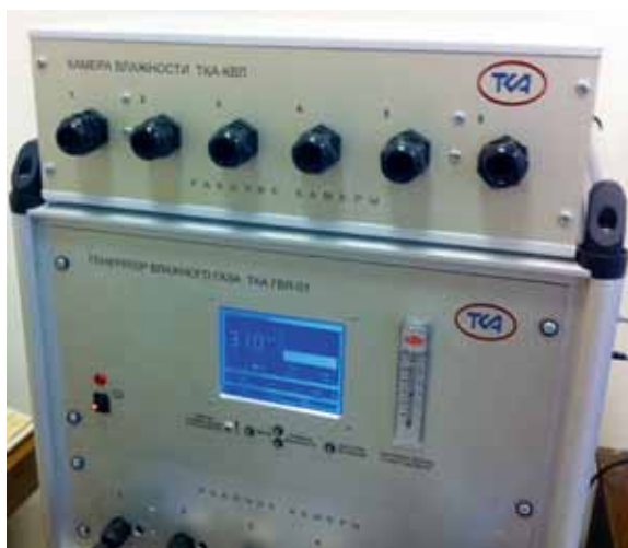
Рис. 4. Камера влажности «ТКА-КВЛ» с 6 рабочими портами
