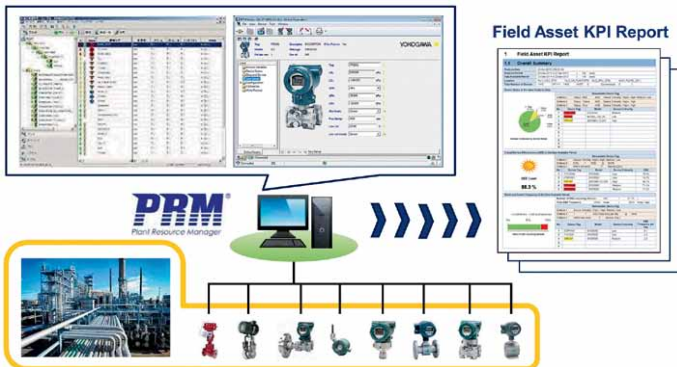
Рис. 1. Производственная система управления ресурсами PRM позволяет не только своевременно выявлять неисправные устройства, но и спрогнозировать их выход из строя (тренды)
