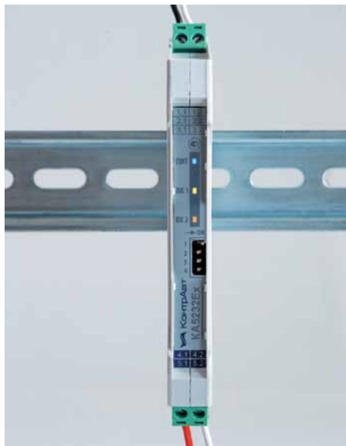
Рис. 4. Индикация режимов работы и DIP-переключатели
