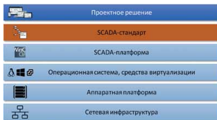
Рис. 1. Упрощенная иллюстрация положения SCADA-стандарта в IT-ландшафте предприятия
