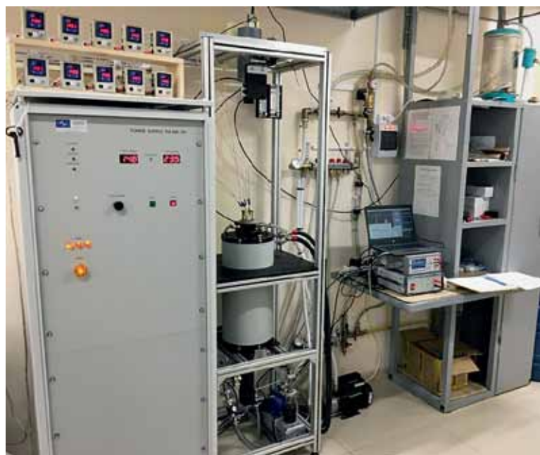
Рис. 1. Внешний вид установки для калибровки высокотемпературных термопар (УКТ-2200) и ее Аттестат № 2411/0042-2020 от 13.01.2020 г.
