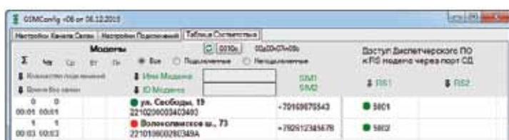
Рис. 7. Вкладка «Таблица соответствия» программы GSMConfig: список модемов, TCP-портов для опроса удаленных устройств, а также индикация и статистика подключений модемов к службе данных PROMODEM GSMService
