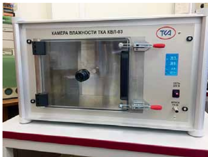
Рис. 5. Камера влажности «ТКА-КВЛ-03», рабочий объем 8,3 л
