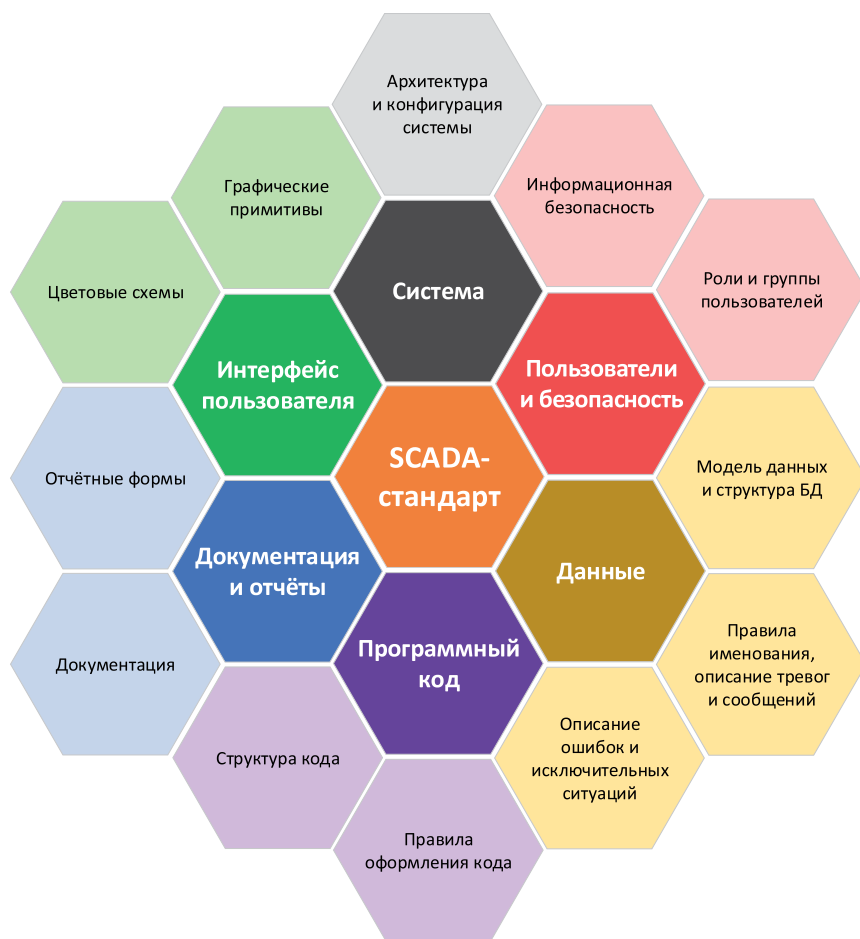
Рис. 2. Объекты и области стандартизации в SCADA-проектах
