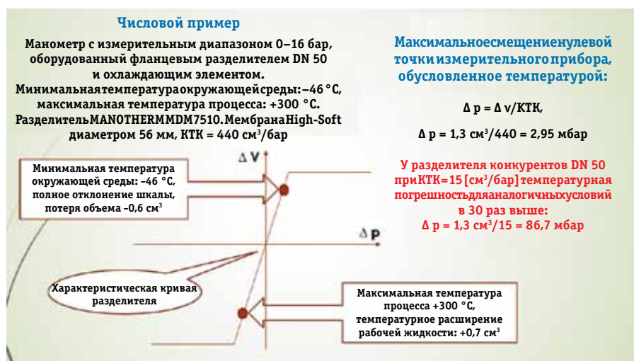
Рис. 3. Характеристики разделителя MANOTHERM и конкурирующего изделия: пример
