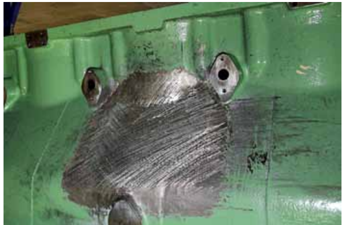
Рис. 1. Ремонт литого изделия методом «Металок»
