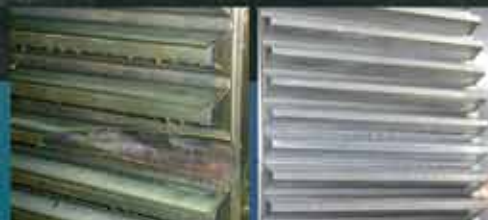
Отремонтированное зубчатое колесо
