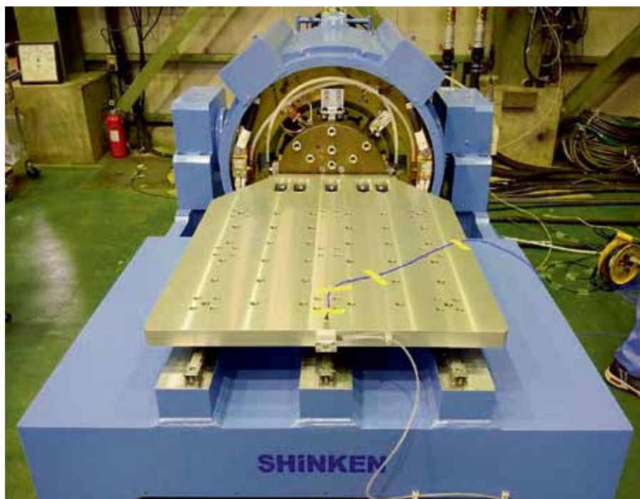
Рис. 3. Вибростенд Shinken G-0230L со столом 700 \times 700 мм на линейных подшипниках
