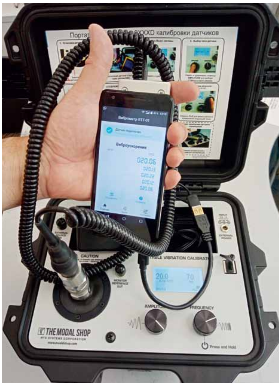
Рис. 2. Сравнение измеренных значений: система «Виброметр ВТТ-01» и эталонный поверочный стенд показывают одинаковый результат
