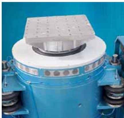
Рис. 4. Расширительный стол 800 × 800 мм
