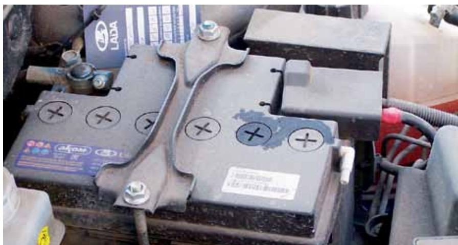
Рис. 2. «Мокрота» возле пробок ячеек – признак разных напряжений на ячейках АКБ
