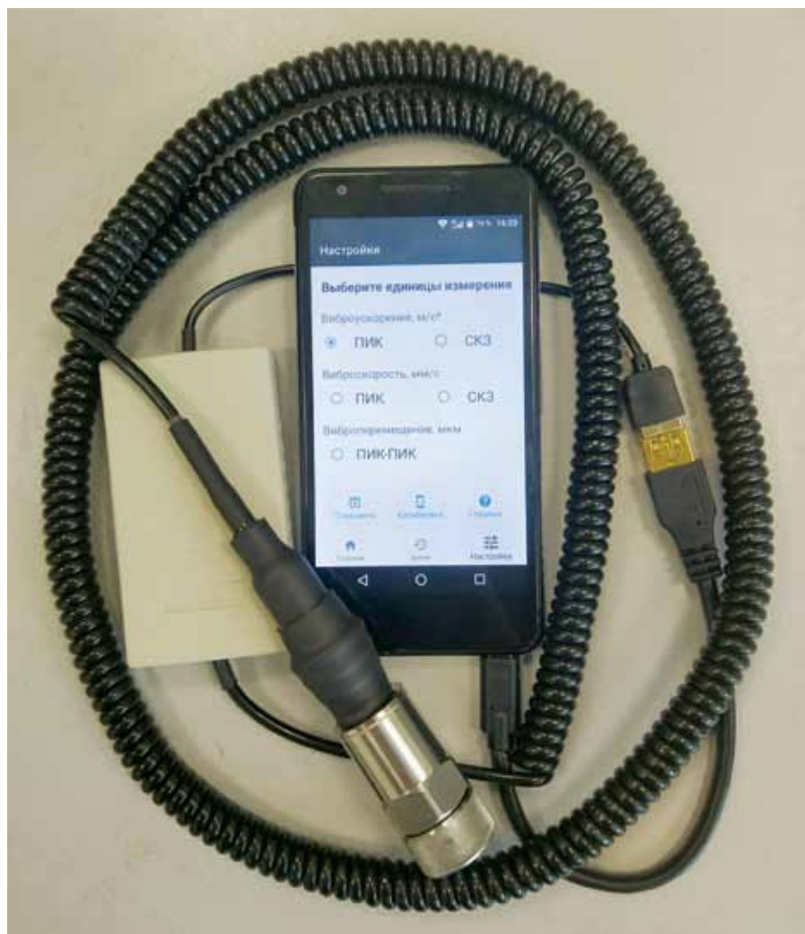
Рис. 1. Виброметр ВТТ-01: полный комплект
