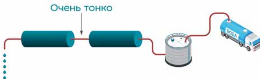
Рис. 5. Скорость потока во всей цепи равна его скорости через минимальное сечение
