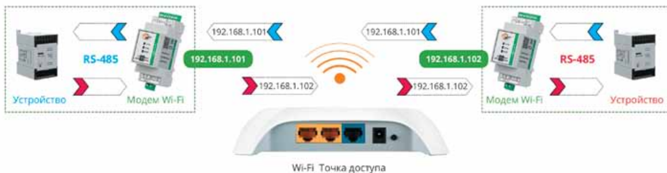
Рис. 6. Радиоудлинитель «точка – точка» RS-485 – RS-485, реализованный с помощью двух Wi-Fi-конвертеров RS-485 PROMODEM Wi-Fi (представлен вариант с внешней точкой доступа, можно и без нее)
