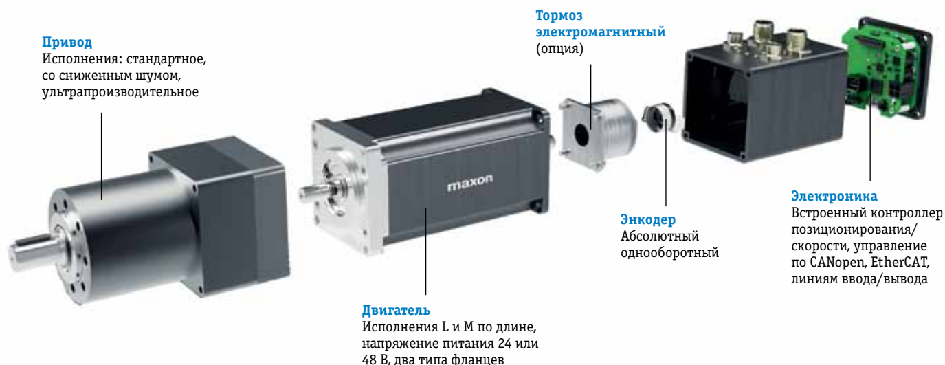
Рис. 3. Устройство привода IDX
