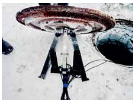
Рис. 1. Датчики системы «СОКОЛ», установленные на устройствах записывания крышки люка: ДАК — с помощью комплекта крепления (слева); ДСА — с помощью крепежной ленты и саморезов (справа)
