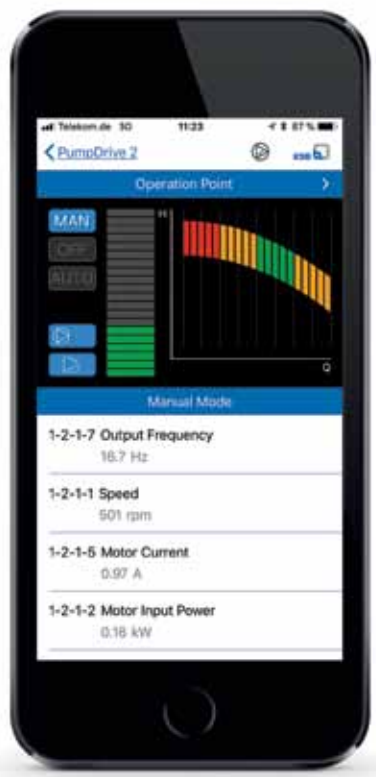
Рис. 4. Настройка ПЧ PumpDrive с помощью мобильного приложения
