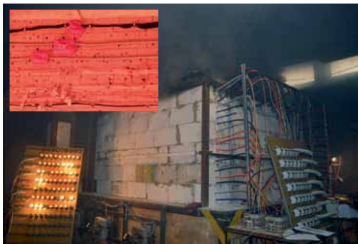
Рис. 3. Внешний вид испытательной печи при испытании ОКЛ «Промрукав»
