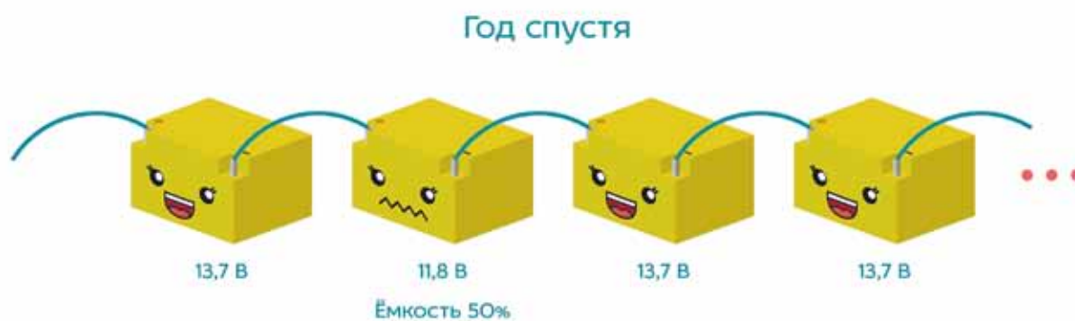
Рис. 6. «Узкий» элемент в цепочке АКБ не зарядится никогда
