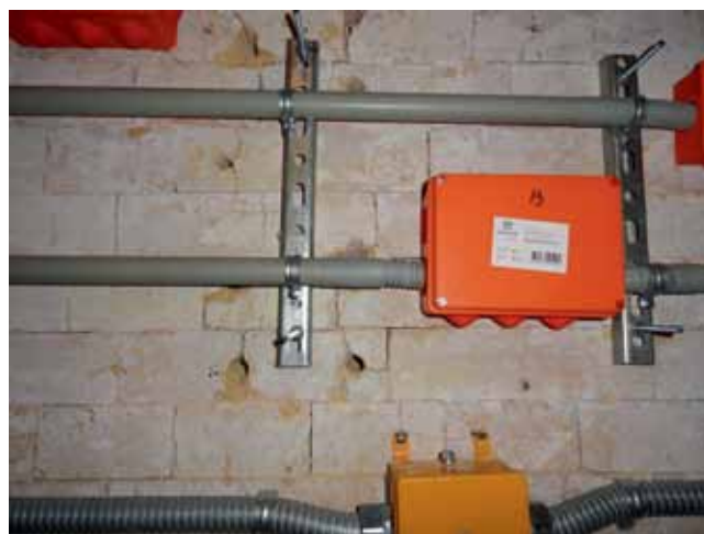
Рис. 4. Монтаж линий ОКЛ «Промрукав» в испытательной печи
