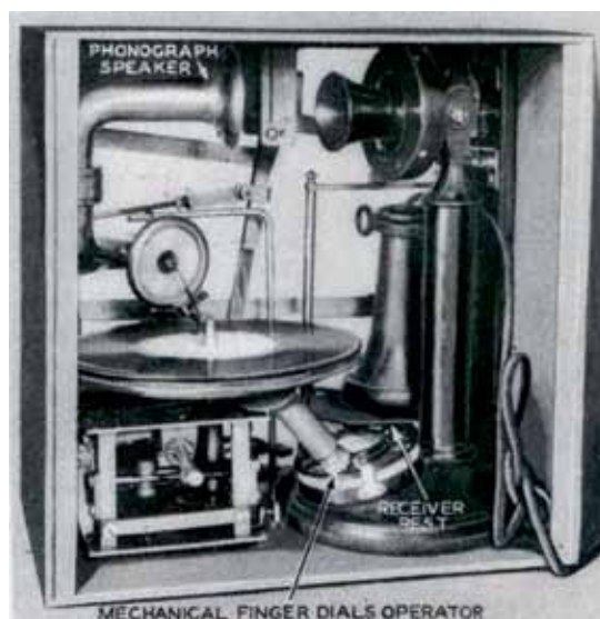
Рис. 2. Автоматический телефонный информатор для пожарной сигнализации. США, 1935 год
