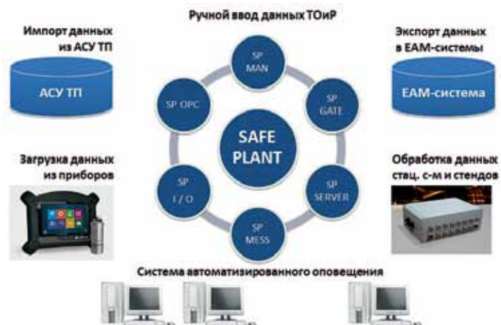
Рис. 1. Платформа SAFE PLANT использует для диагностики технические данные, полученные от всех систем предприятия
